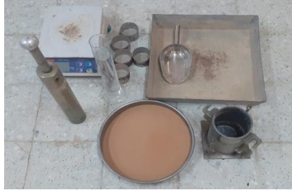
شكل 4 يوضح المعدات المستخدمة في اختبار الدمك القياسي.
