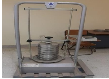
شكل 3 يوضح جهاز الهز والمناخل المستخدمة في اختبار التحليل المنخلي.
